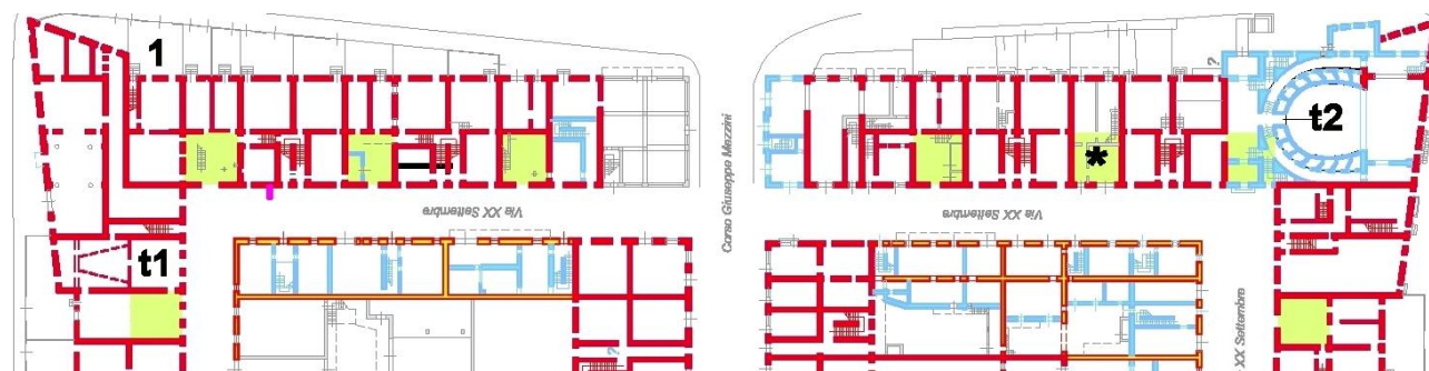
26 - Permanenza dei sistemi strutturali storici nell'impianto attuale.
