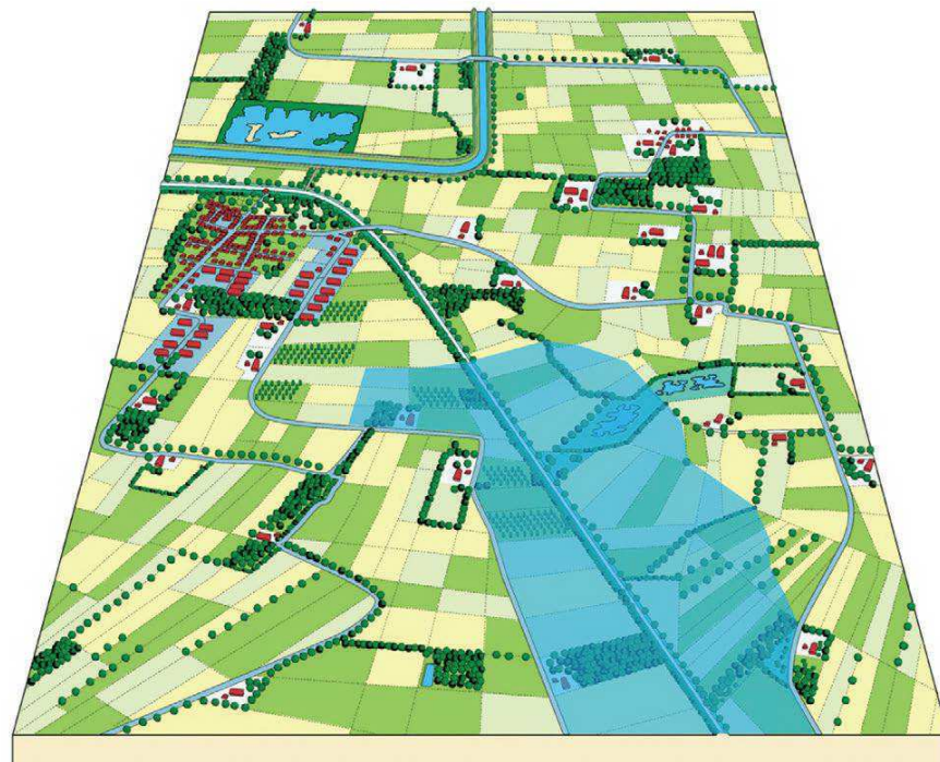
Figura 21 - Aree per l'esondazione controllata delle piene nei terreni agricoli. In alto: nell'esempio il canale indicato in figura causa problemi di esondazione su un centro abitato (aree azzurre). In basso: grazie ad accordi con i proprietari dei terreni agricoli, in caso di piena le acque inondano temporaneamente le aree di loro proprietà (aree azzurre), evitando così problemi alle zone più urbanizzate poste a valle. (Immagine: rielaborata da materiale prodotto nell'ambito del progetto LIFE ECONet)
