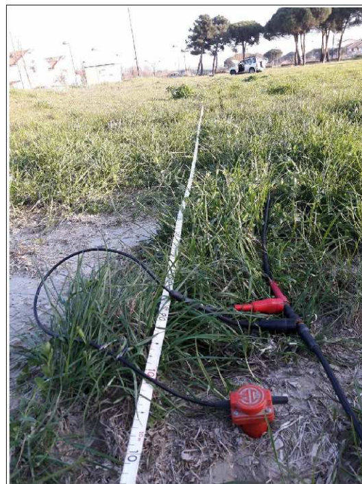
Foto 4.5 - Prova ESAC eseguita a Pinarella (in adiacenza alla prova "Down-Hole")
