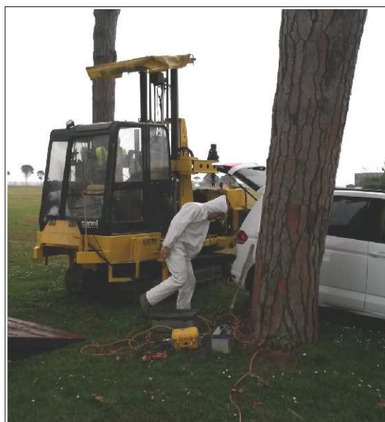
Foto 4.4 - Prova SCPTU eseguita A Castiglione di Cervia (Cimitero)
