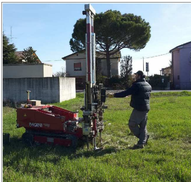
Foto 4.3 Prova CPTU eseguita a Cannuzzo
