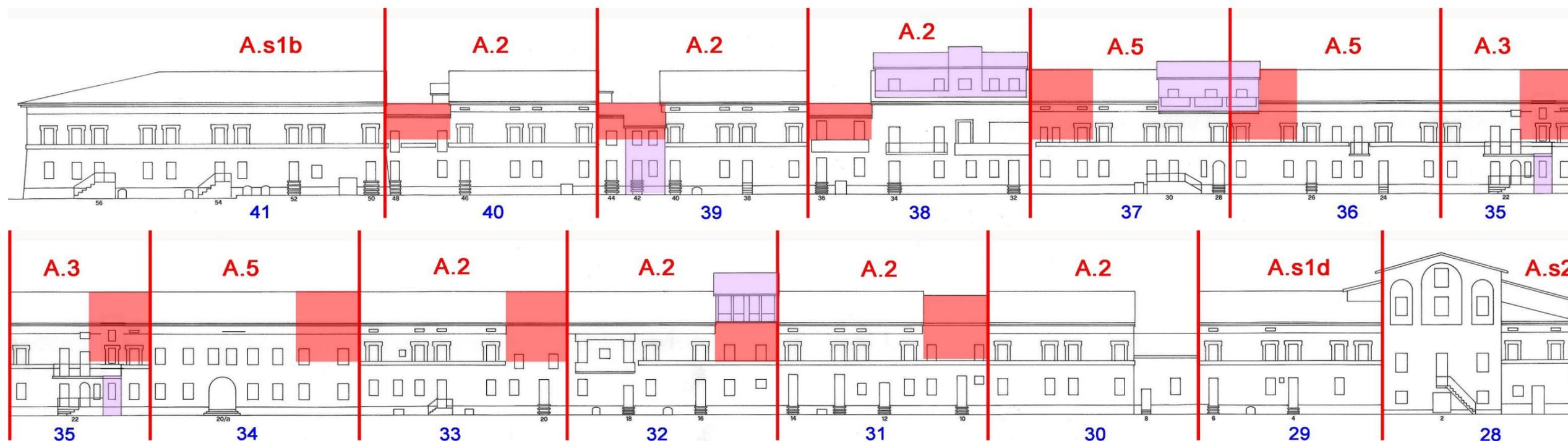
32 - Schemi grafici dei prospetti esterni (Circonvallazione Sacchetti) del lato ovest del Quadrilatero. Il servizio interno presente nel cortile, in origine ad un piano, viene nella maggior parte dei casi sopraelevato parzialmente o completamente conservando, in genere, l'allineamento prevalente del fronte. Sono presenti alcuni casi di ulteriori sopraelevazioni e ampliamenti fuori sagoma.
