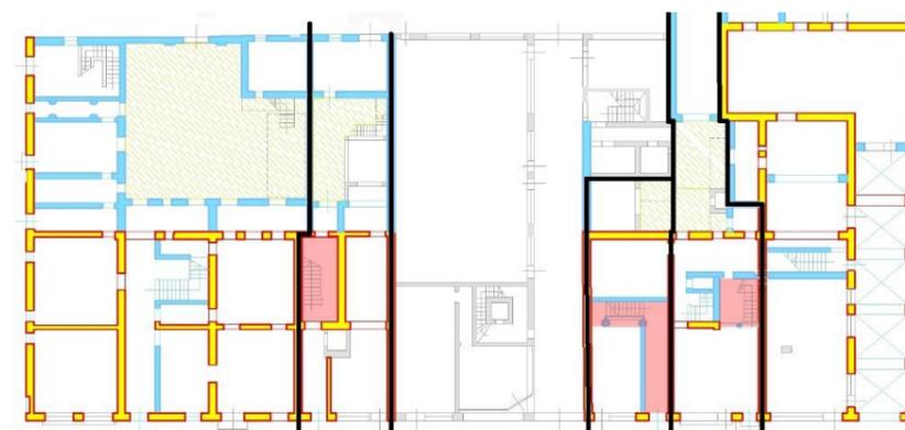
**42** – Tipo B.2. Sono evidenziate 3 unità a schiera e le nuove scale inserite nelle cellule dell'edificio già esistente. I muri in giallo sono le permanenze dell'impianto di fondazione realizzato nel 1711
