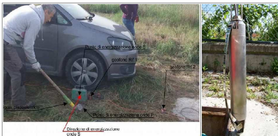
Foto 4.2 - prova "Down-Hole" e geofono utilizzato per le misure in foro
