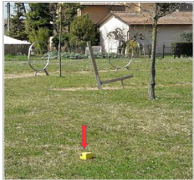
Foto 4.6 - Registrazione dei microtremori sismici eseguita per questo studio. La freccia rossa indica lo strumento in fase di registrazione
