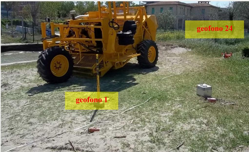
Foto 1 – Profilo sismico
