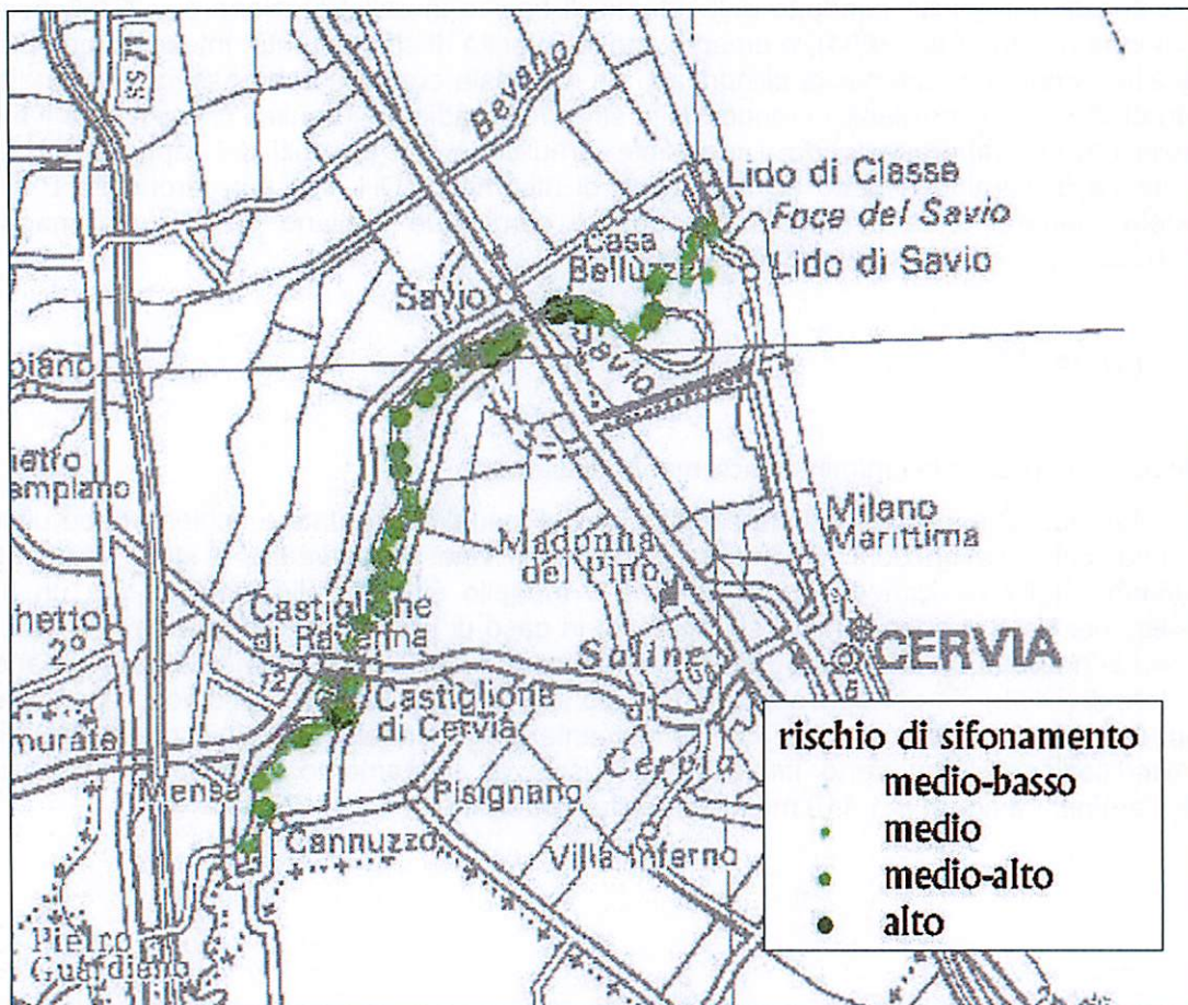
Fig. B.1.110 - Distribuzione qualitativa del rischio di sifonamento. Da: Piano Stralcio di Bacino per il Rischio Idrogeologico dell'Autorità dei Bacini Regionali Romagnoli – Variante al Titolo II "Assetto della rete idrografica" approvata nel 2011.
