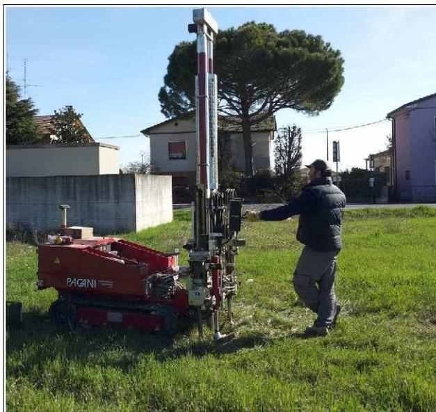
Foto 4.3 Prova CPTU eseguita a Cannuzzo
