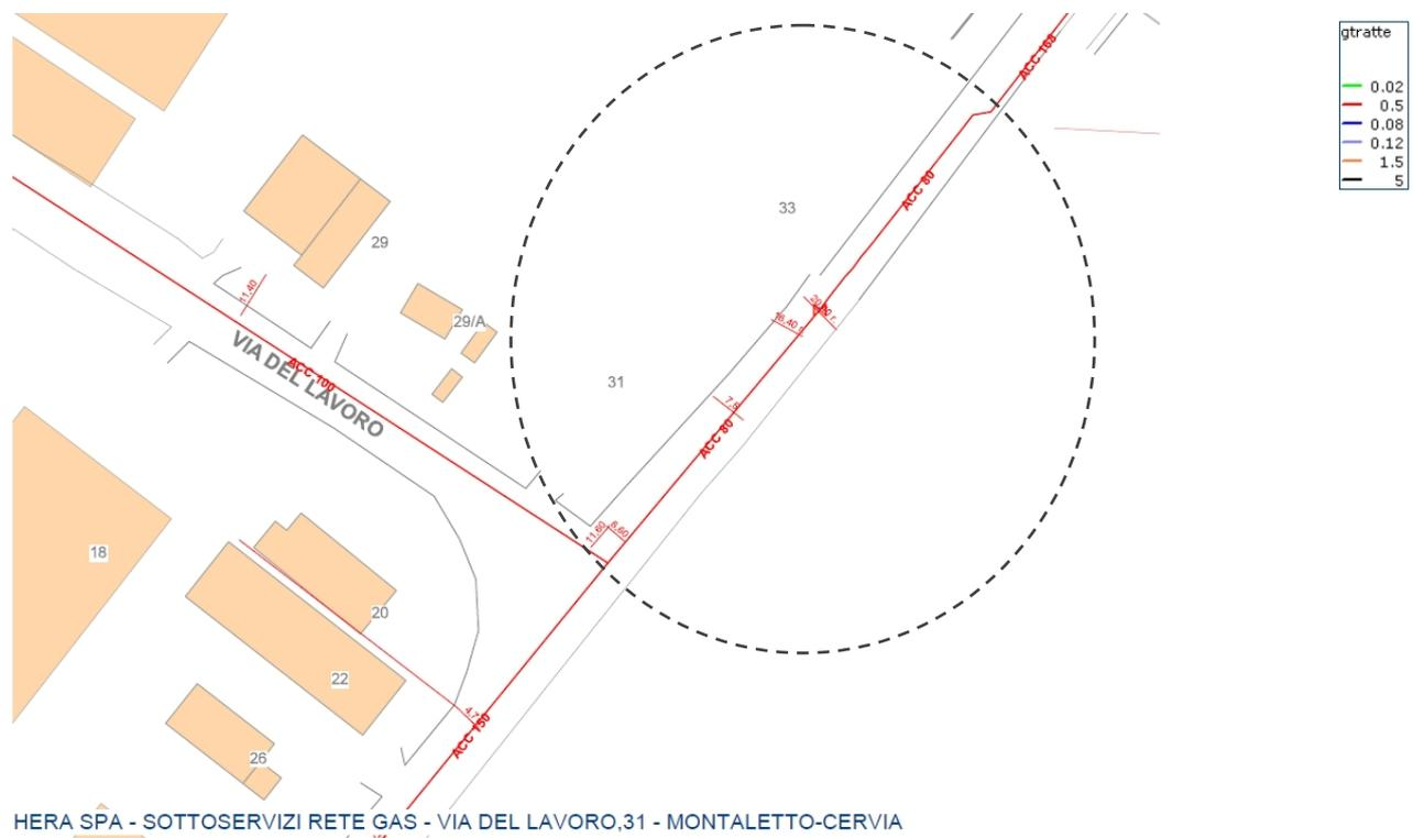
La posa delle tubazioni del gas, all'interno del comparto, avverrà in contemporanea con quelle dell'acqua in modo da ridurre i costi di scavo e
