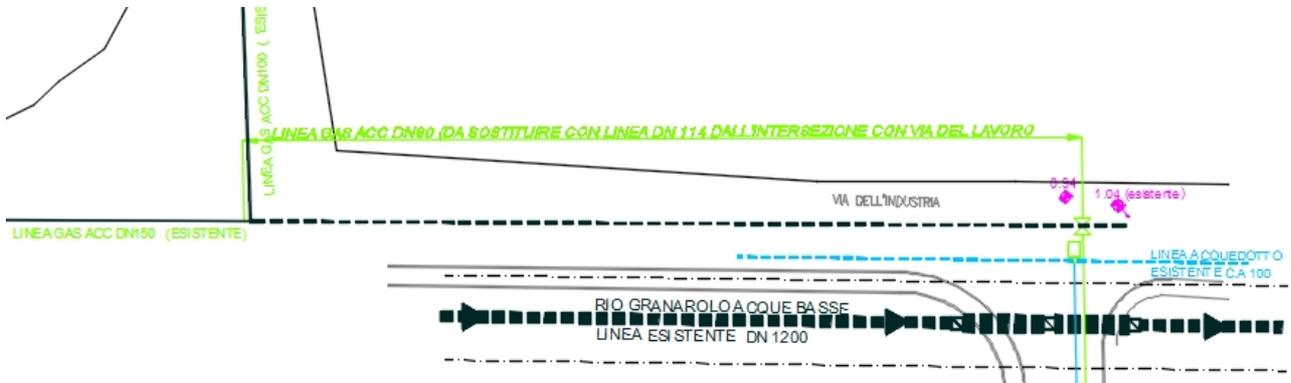
Il tracciato della nuova linea dell'acqua del comparto è prevista in DE 110 PN16. Sono state previste le bocche di scarico e o lavaggio a monte e valle della nuova linea è stato inserito un idrante a colonnina in prossimità delle nuovo parcheggio.
