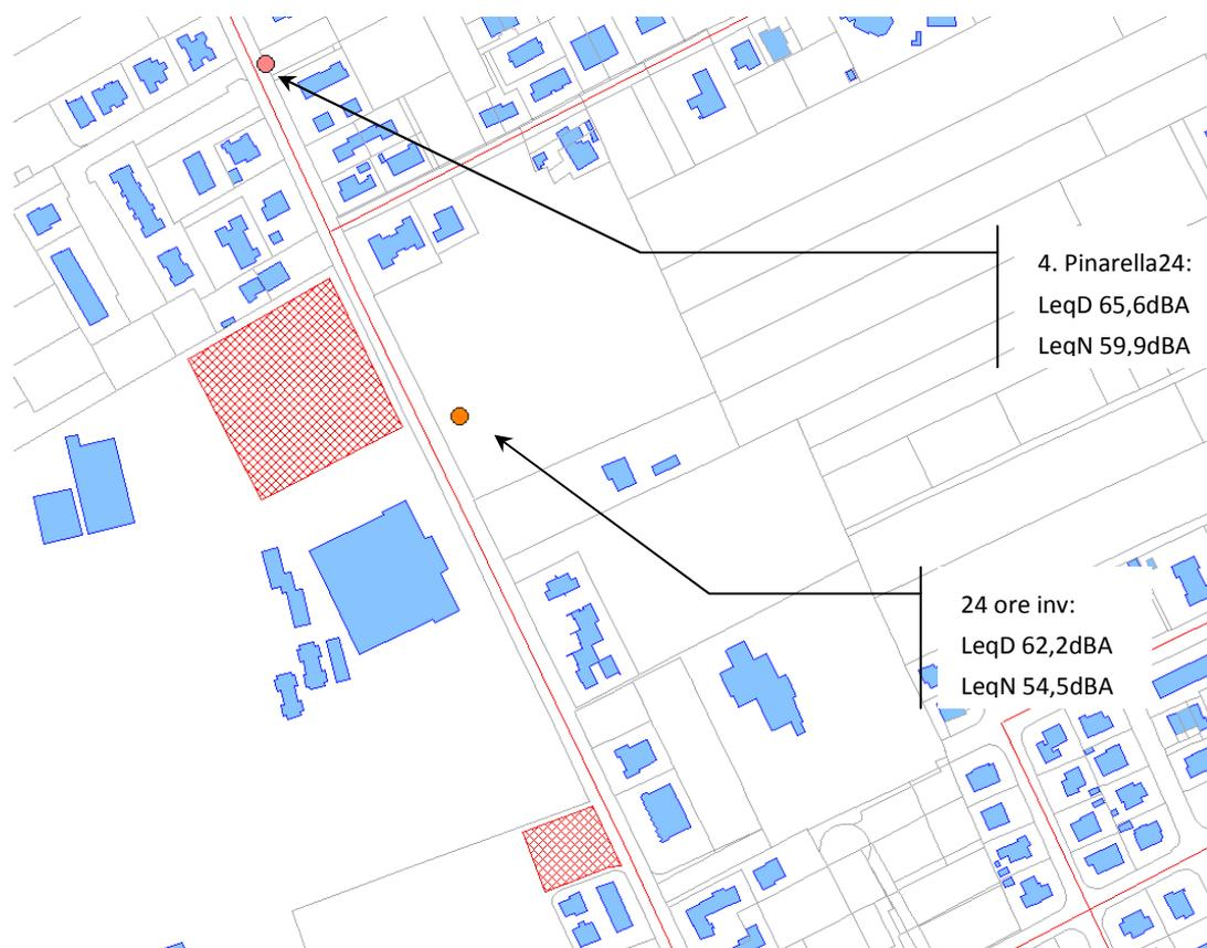
*Figura 13– Localizzazione planimetrica dei punti di misura su cui si è effettuato il calcolo*
