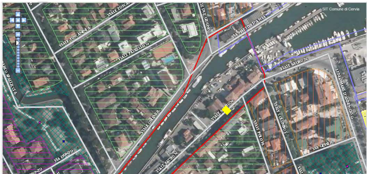
Figura 2 Stralcio PRG: con la linea rossa si identifica il centro storico, con linea blu il territorio urbanizzato e con il giallo l'area di progetto.
